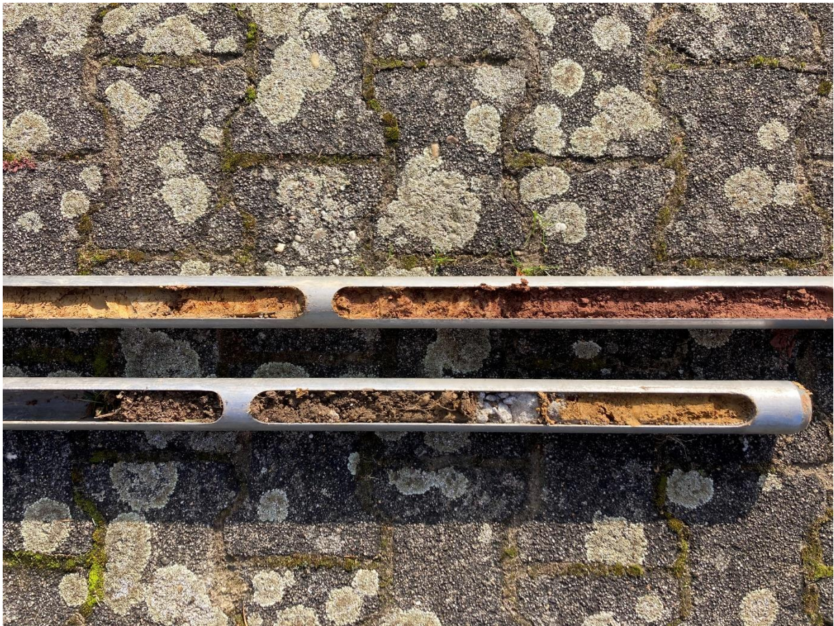
Bild 3: Friedhof Spielberg: Blick auf das Bohrgut von RKS 3; untere Stange zeigt den Bodenaufbau bis 1 m Tiefe; obere Stange zeigt den Bodenaufbau von 1,2 – 2,0 m Tiefe
